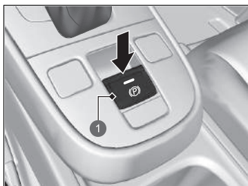
1 Spínač elektrické parkovací brzdy
