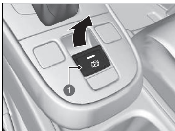
1 Spínač elektrické parkovací brzdy
