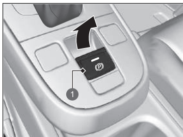
1 Spínač elektrické parkovací brzdy
